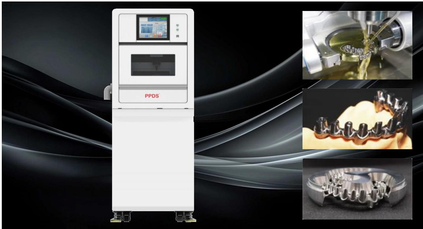
Ideal Mill (アイデアルミル) Sは、ドイツの設計理念を受け継ぎ、強固なスチールフレームと強力・高性能スピンドルを搭載して、高い剛性と安定性を持っています。湿式加工と乾式加工の切替使用が可能です。
